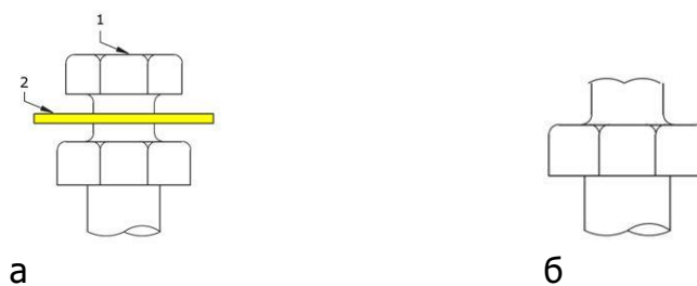
Рис. 8 Болт со срывной головкой: а – до монтажа; б – после монтажа; 1 – срывная головка болта; 2 – цветная бирка.
